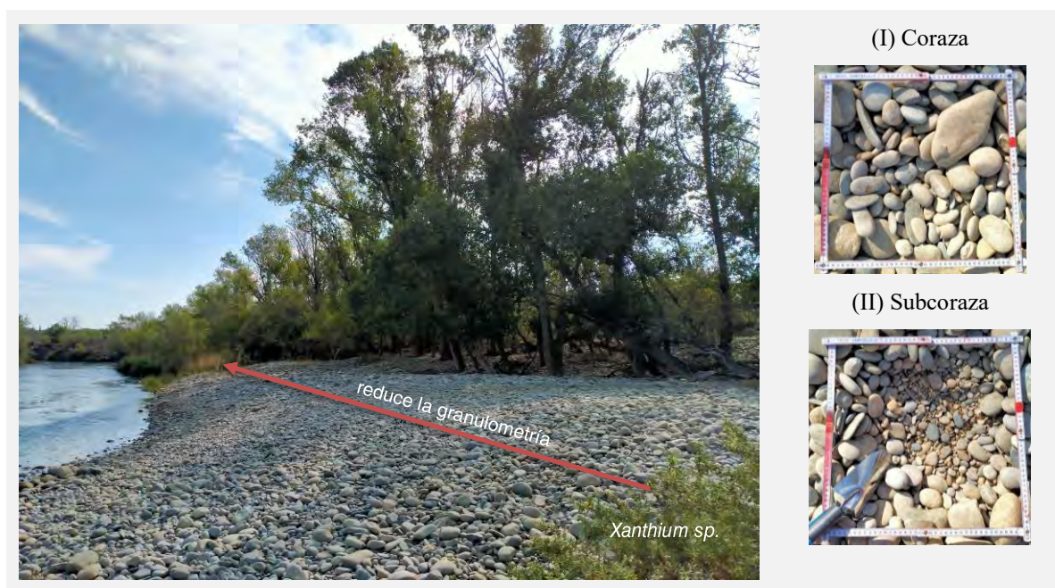
Figura 36. Granulometría Barra lateral en tramo 3. Fotografías de la autora (1/09/23).
