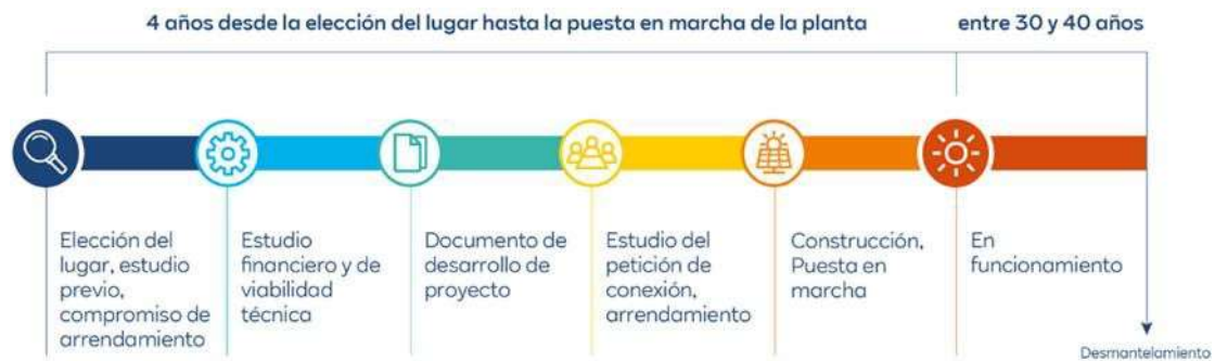
Figura 5. Procedimiento para el desarrollo de un parque fotovoltaico. Fuente: RWE.com
